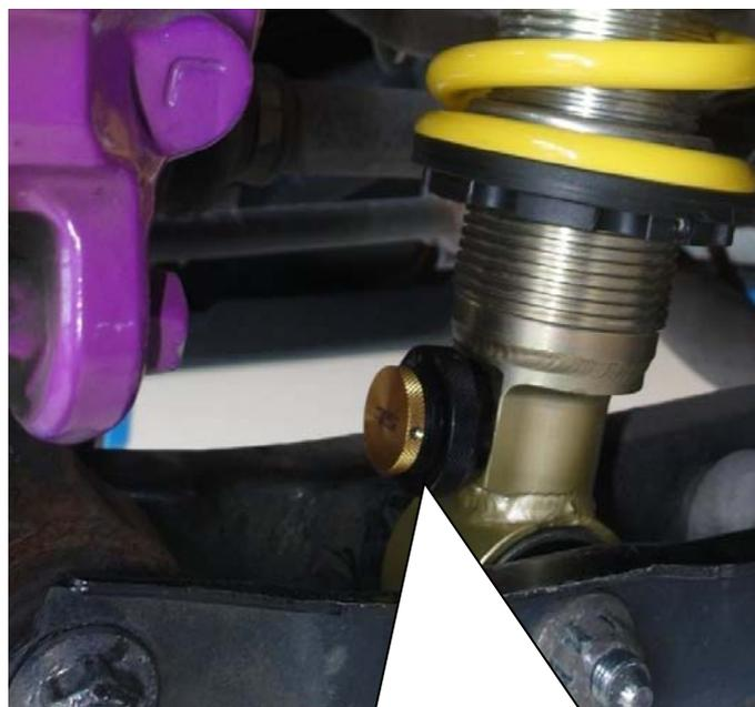
パンプ調整付きダンパーの場合、写真のように調整ダイヤルをホイール側に向けて取り付けます。
